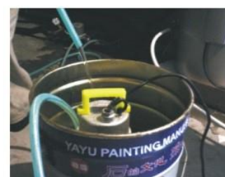
Utilizando la bomba sumergible llene de líquido hasta la mitad
