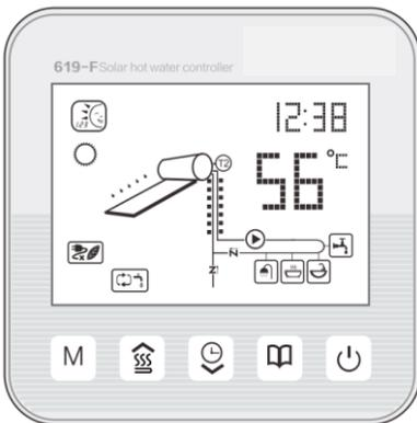
Normalmente, la temperatura de T2 se muestra en la pantalla (temperatura del agua en el tanque).
